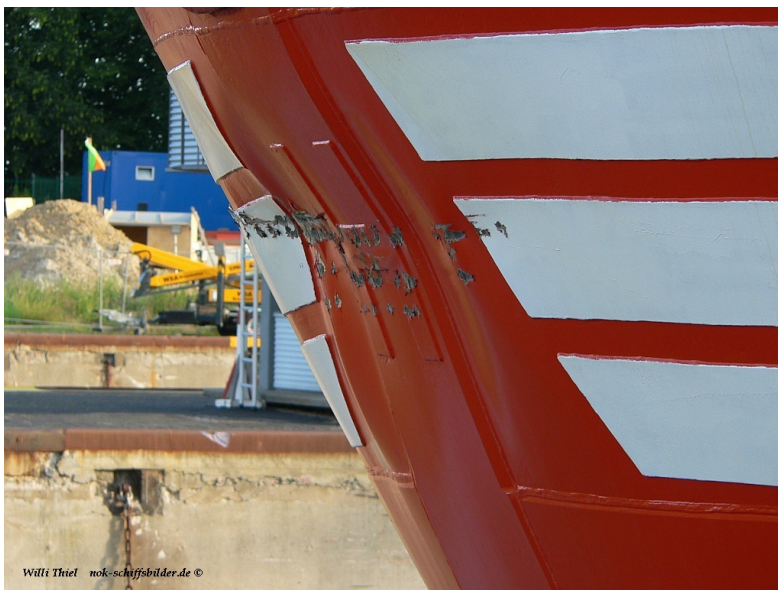
Leicht eingedrückter Bug der " CRYSTAL TOPAZ" nach Havarie mit Tor 1Nordkammer Schleuse am 4 Juli 2010
