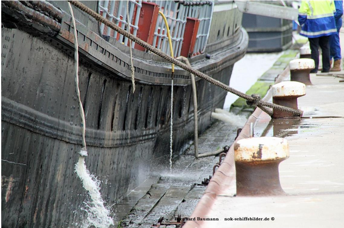
Loch Backbord-Luftkammer/Bagger Krüger
